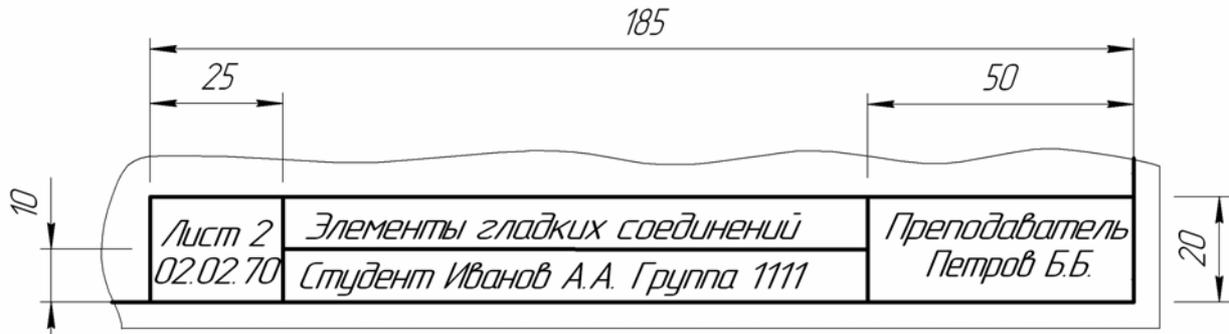
Рис. 23. Размеры и пример заполнения упрощенной основной надписи
