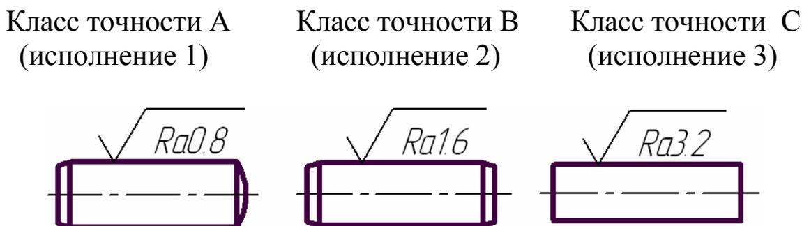
Рис. 5. Классы точности и исполнения цилиндрических незакаленных штифтов
