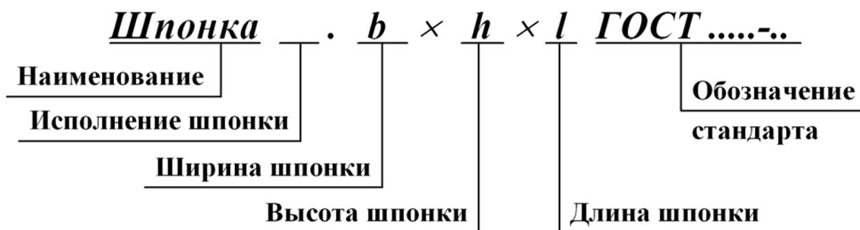
Примеры условного обозначения призматической шпонки без покрытия шириной  $b = 8$  мм, высотой  $h = 7$  мм, длиной  $l = 24$  мм: исполнения 1
